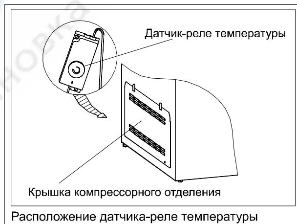
Расположение датчика-реле температуры
